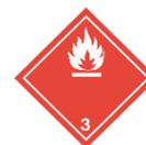
Nombre para la documentación de transporte: UN1993; FLAMMABLE LIQUID, N.O.S. (contains gas oil); Class 3; PG II; Flash point 18°C (64,4°F) c.c.
