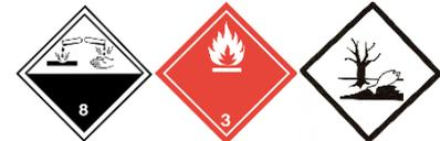
Nombre para la documentación de transporte: UN2920; CORROSIVE LIQUID, FLAMMABLE, N.O.S. (contains amines, isopropanol and n-propanol); Class 8 (3); PG II; MARINE POLLUTANT; Flash point 30°C (86°F)
