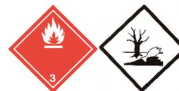
Nombre para la documentación de transporte: UN1993; FLAMMABLE LIQUID, N.O.S. (contains kerosene); Class 3; PG III; MARINE POLLUTANT; Flash point 48°C (118°F) c.c.
